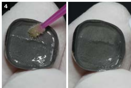
4 Applicazione di 3M™ Scotchbond™ Universal Plus adesivo, seguita da assottigliamento con getto d'aria.
